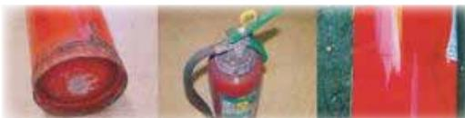
腐食が進んだ消火器を操作した際に消火器が破裂し、負傷等する事故が発生しています。腐食が進んだもの、凹みや変形した消火器は絶対に使用しないでください。
